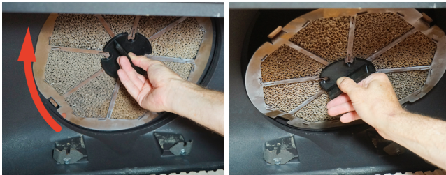
Lockern und entfernen der Katalysatoreinheit mit Hilfswerkzeug
