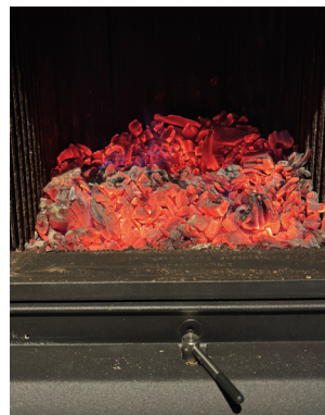
Glutbett ohne Flammen - Abbrand beendet
