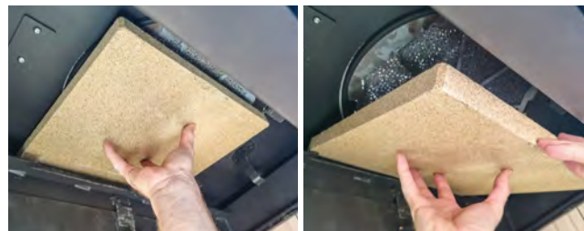
Odstranitev zgornje deflektorske plošče
