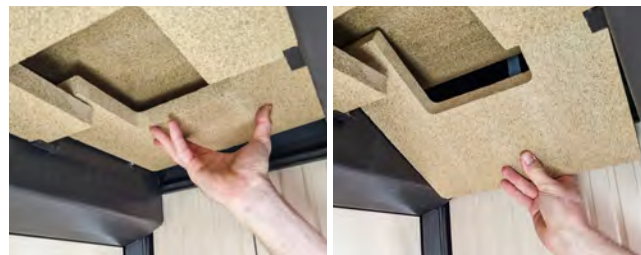
Procédure de retrait des plaques déflectrices inférieures
