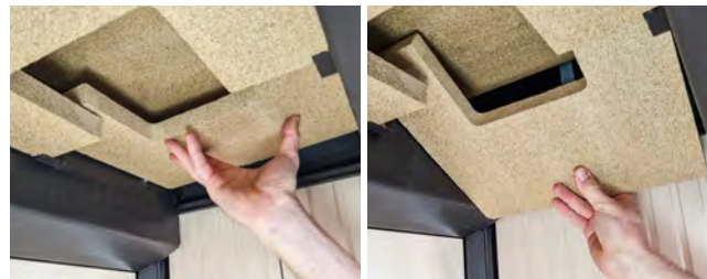
Förfarande för borttagning av de nedre rökvändar-plattorna
