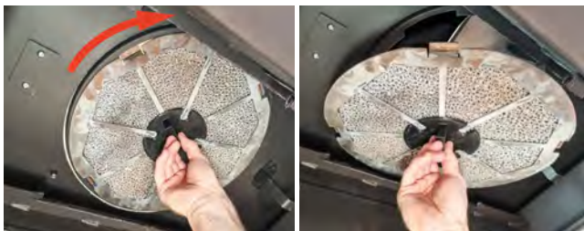
Desserrer et retirer l'unité catalytique avec un outil auxiliaire
