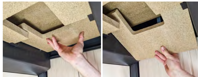
Postup demontáže spodních deflektorů
