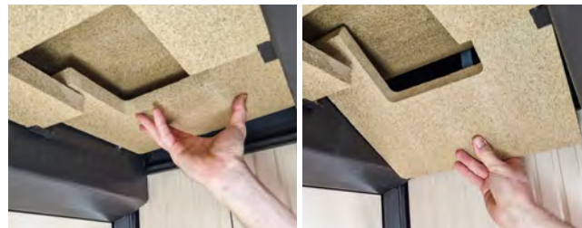
Odstranitev spodnjih deflektorskih plošč
