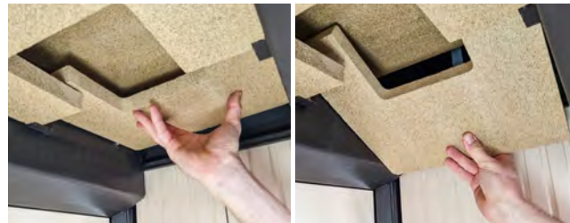
Postępowanie przy wyjmowaniu dolnych płyt deflektora.
