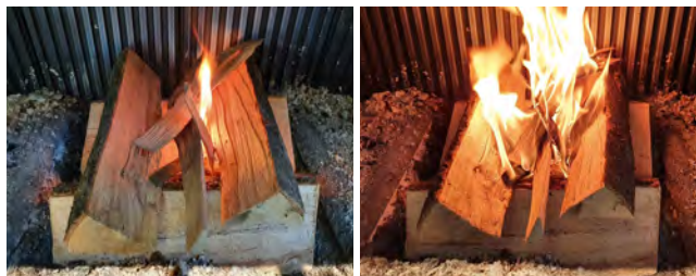
Popoln postopek prižiganja v kurilni posodi zgorevalne komore z vžigalnikom in zažigalnikom ognja med zgornjo plastjo lesenih polen.
