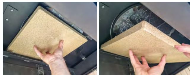
Procédure de retrait des plaques déflectrices supérieures.
