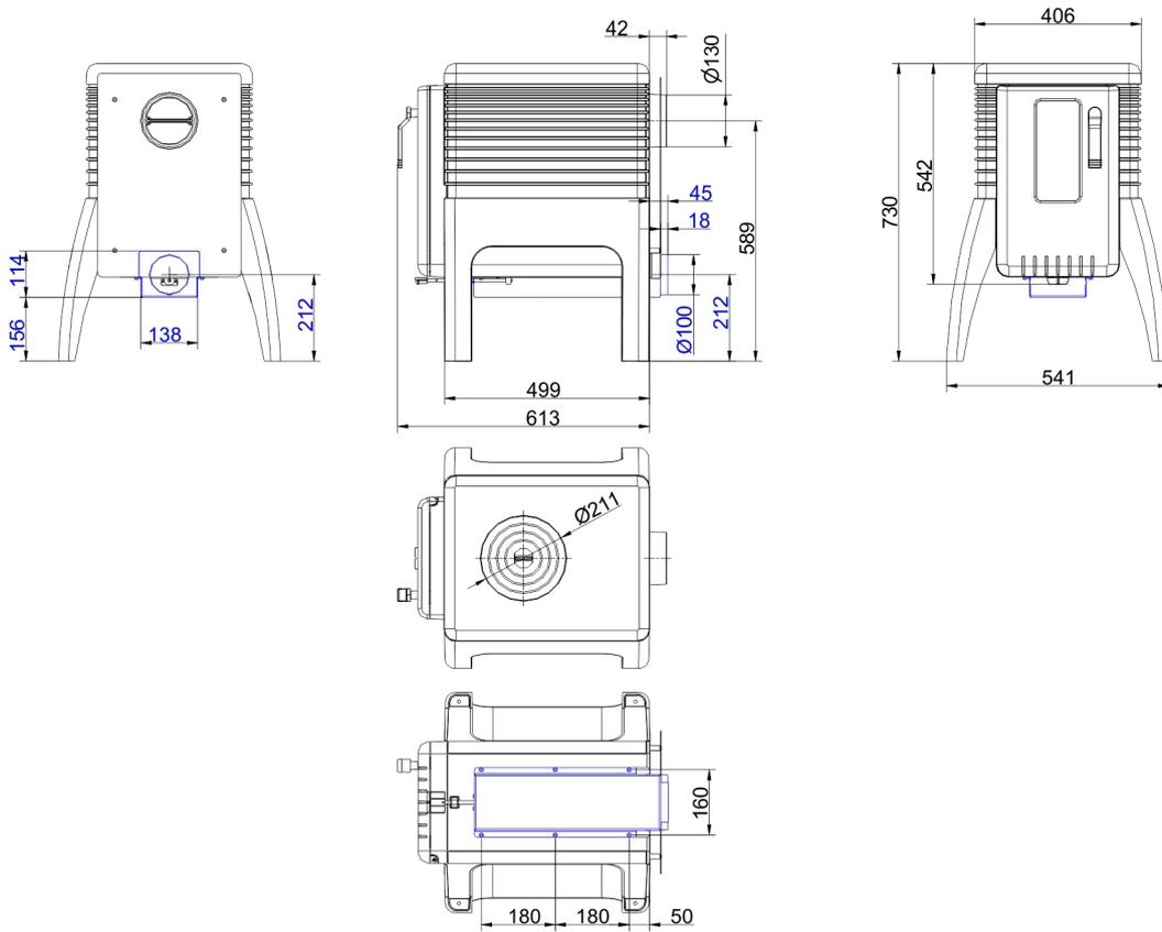
**... mit Anschluss für Verbrennungsluft**
