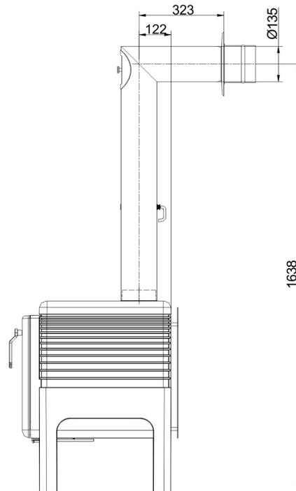
... mit Abgasrohr-Anschlussset horizontal und L
