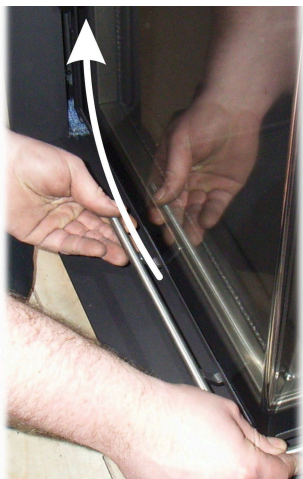
Abb. 4: Schließen der Eck-Feuerungstür links
